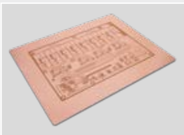
FR4-Leiterplatten strukturieren und schneiden
