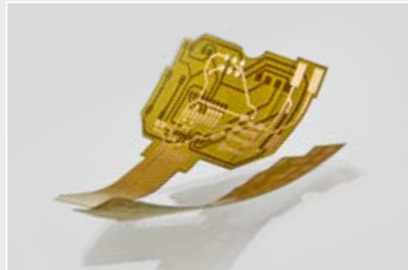
Schneiden und Strukturieren von ein- und doppelseitigen kaschierten, flexiblen Elektronikmaterialien (DuPont Pyralux)
