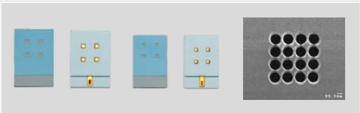
Der UV-Laser schneidet, graviert und bohrt mechanisch empfindliche Substrate, beispielsweise LTCC-Komponenten.
