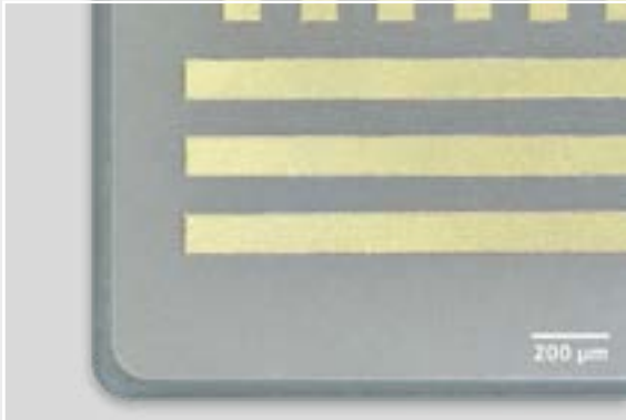
Schneiden von GaN und geometrisch exakter Abtrag von \mu\text{m} -starken Kupfer-/Gold-Beschichtungen
